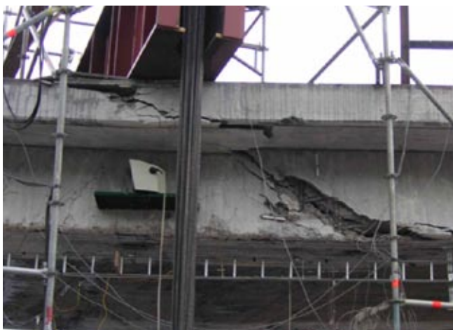
Jernbanebro ved Örnsköldsvik, Sverige, forstærkes med kulfiber, og belastes derefter til brud. EU-forskningsprojektet „Sustainable Bridges“.
